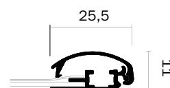
Espositore porta avviso, porta comunicazioni con piantana e cornice a scatto, disponibile nel formato A4/A3. La cornice è orientabile sia in verticale, sia in orizzontale. Singolo montante a sezione tonda 30 mm. Cornice profilo frame 25 mm, ad angoli tondi completa di foglio di protezione frontale in PVC antiriflesso.
