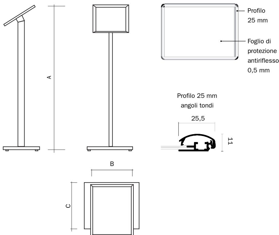
Espositore porta avviso, porta comunicazioni con piantana e cornice a scatto, disponibile nel formato A4/A3 orizzontale inclinata a leggjo. Versione monofacciale, colore grigio. Composta da singolo montante a sezione ellittica 28x52 mm, con 1 cornice a scatto profilo frame 25 mm, ad angoli tondi completa di foglio di protezione frontale in PVC antiriflesso. Base in MDF con 4 piedini in gomma neri.
