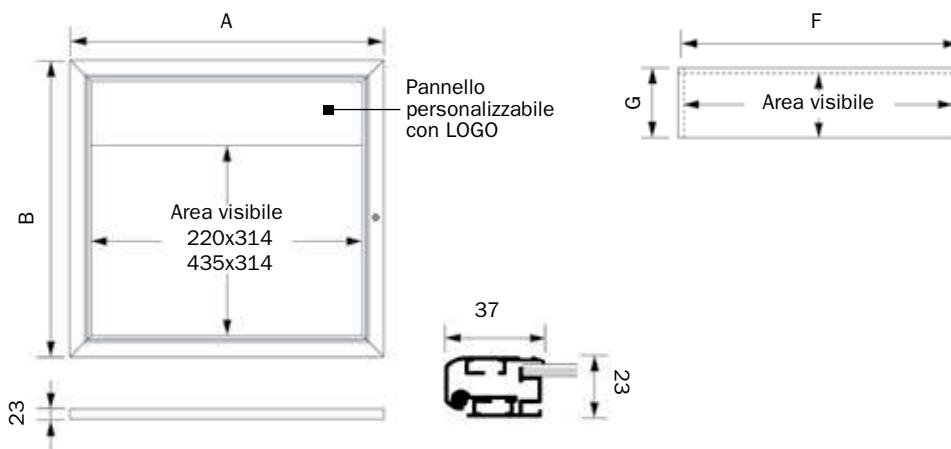
Bacheca per esterni autoportante con base in acciaio finitura nera. Fondo in metallo magnetico e scrivibile per formati 1xA4 e 2xA4. Anta in polycarbonato trasparente. Apertura a ribalta con serratura e chiavi in dotazione. Pannello di intestazione personalizzabile con logo o rimovibile.
