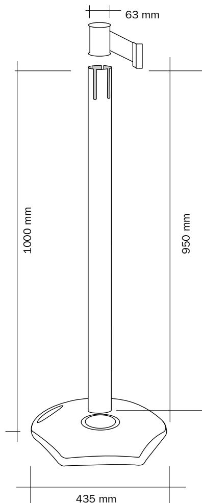
Colonnine segna percorso per esterni con montante in PVC rosso o giallo con base in plastica riciclata nera con maniglia per il trasporto. Dotate di sistema tendinastro autofrenante e 3 agganci riceventi. Nastro in polipropilene altezza 48 mm, resistente agli agenti atmosferici di lunghezza 3,5 mt con clip di sicurezza finale. Peso totale kg 8,5. Adatte per uso esterno.
