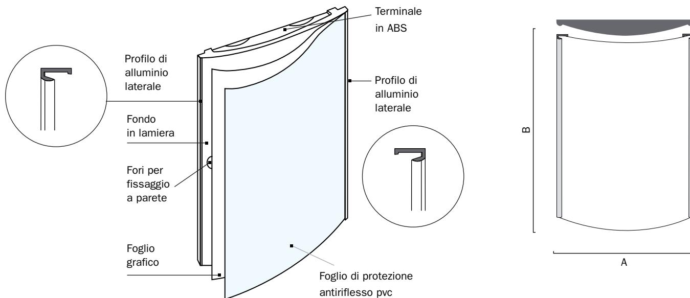
Targa a parete linea BETA 2 con profili laterali in alluminio e fondo convesso in lamiera. Terminali in ABS color silver, posizionabili ai lati destro/sinistro o sopra/sotto. Foglio di protezione in PVC antiriflesso per la gestione di grafica intercambiabile. Profili disponibili in quattro misure di larghezza: 210, 300, 420, 600 mm. Fissaggio a parete con biadivo oppure con viti e tasselli.
