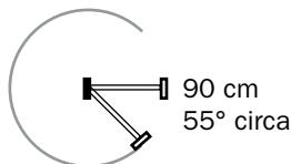
Pannelli divisorii autoportanti doppi, concatenati con possibilità di rotazione sull'asse centrale, composti da struttura in alluminio anodizzato silver diametro 30 mm. Pannelli con policarbonato alveolare semi trasparente. Un prodotto utile per creare partizioni e separè, in ambienti interni. Per uffici, negozi, stand, hotel, ristoranti, e qualsiasi ambiente interno.
