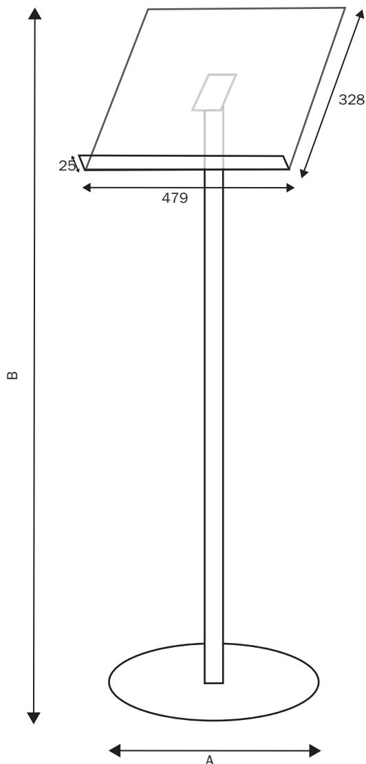
Espositore a leggio con ripiano A3 e appoggio. Leggio interamente in metacrilato trasparente spessore 4 mm su montante diametro 40 mm, base diametro 360 mm. Leggio posto sulla parte superiore per formato A3 orizzontale con mensola reggi-libro da 25 mm.
