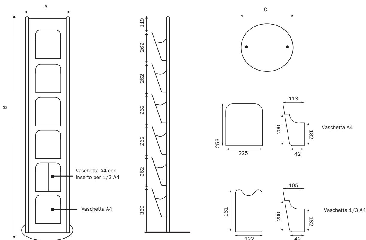
Espositore porta depliant, composto da profili in alluminio anodizzato silver e struttura in metacrilato coprente o trasparente, disponibile in diversi colori. Tasche in metacrilato trasparente di spessore 2 mm in formato A4 con inserto removibile (PBS516T-PBS530-PBS544) e per formato 1/3 A4 (PBS5301). Versione monofacciale o bifacciale, base fissa di spessore 6 mm o girevole di spessore 40 mm.
