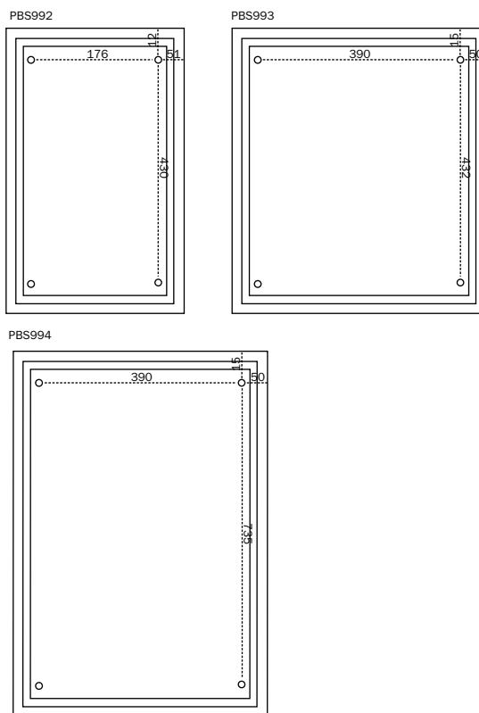
Bacheca per esterni con fondo in acciaio laccato magnetico e scrivibile per formati 1xA4, 2xA4 e 4xA4. Struttura in alluminio anodizzato silver. Anta in policarbonato trasparente. Apertura a libro con serratura e chiavi in dotazione. Pannello di intestazione personalizzabile con logo o rimovibile.
